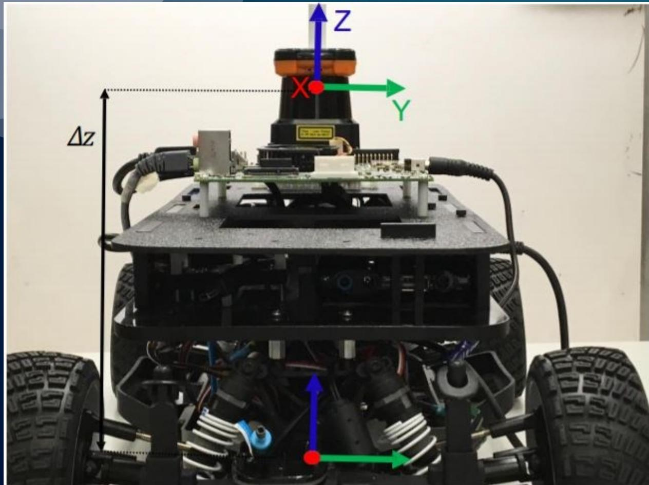
很明显，来自激光雷达的数据，并不能准确得到前方障碍物的位置，必须考虑不同坐标系带来的偏移量
